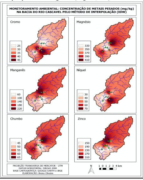
Environmental monitoring: concentração de metais pesados (mg/kg) Na bacia do rio cascavel pelo método de interpolação (idw)
